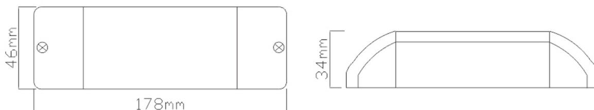
Габаритная схема аккумуляторной батареи
